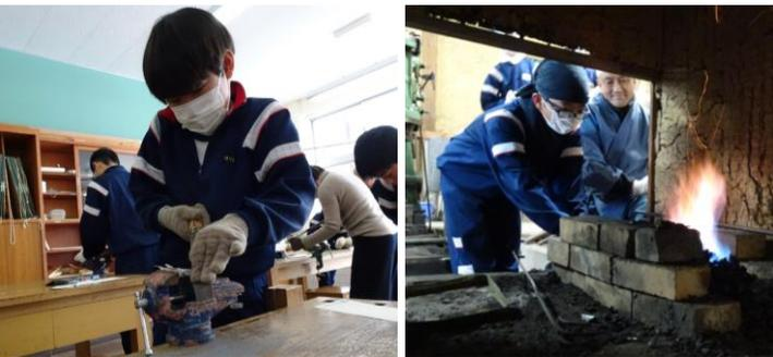
1～2月に「たたら学習」の一環で、鋼の板を小刀の形に加工し、焼入れ体験をしました。使用した鋼の板は、子どもたちが作った木炭、集めた砂鉄を使って「小だたら操業」でできた鋼を精錬されたオリジナルのものです。
